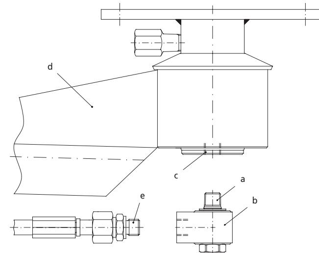
1. Die Hohlschraube (a) des Winkeldrehgelenkes (b) an die Verschraubung (c) der Montage-Einheit (d) (z.B.: Deckenkreisel) montieren.
