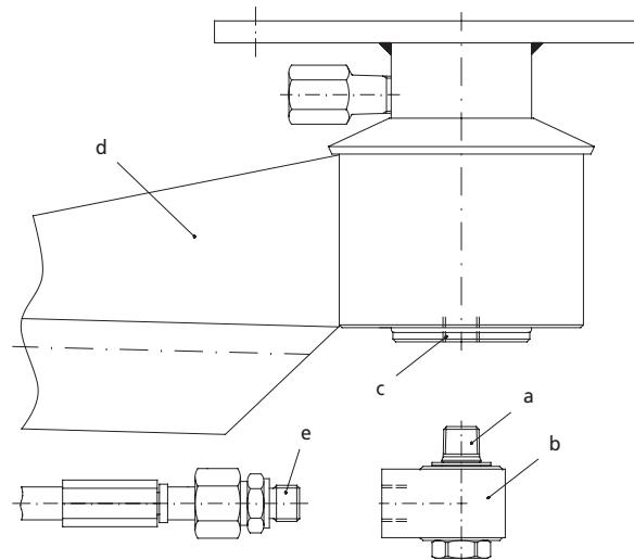
1. Die Hohlschraube (a) des Winkeldrehgelenkes (b) an die Verschraubung (c) der Montage-Einheit (d) (z.B.: Deckenkreisel) montieren.
