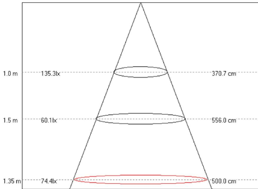
Altura (m) Lux (lx) Ángulo vertical (50%) Ángulo horizontal (50%) Diámetro (cm)
