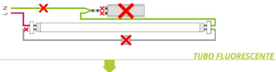
**PASO 3:** Conectar la FASE (cable marrón, negro o gris) a un pin (1 de las 2 patas metálicas) en un extremo del portatubos y el NEUTRO (cable azul) al otro pin del mismo extremo del portatubos. Colocar el Tubo LED con el extremo indicado mediante una etiqueta en el portatubos cableado. Encender y comprobar que tu nuevo tubo LED se enciende.
