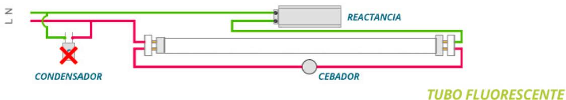
**PASO 3:** Cambiar el cebador por el LED starter y el tubo fluorescente por el tubo LED. Encender y comprobar que tu nuevo tubo LED se enciende.
