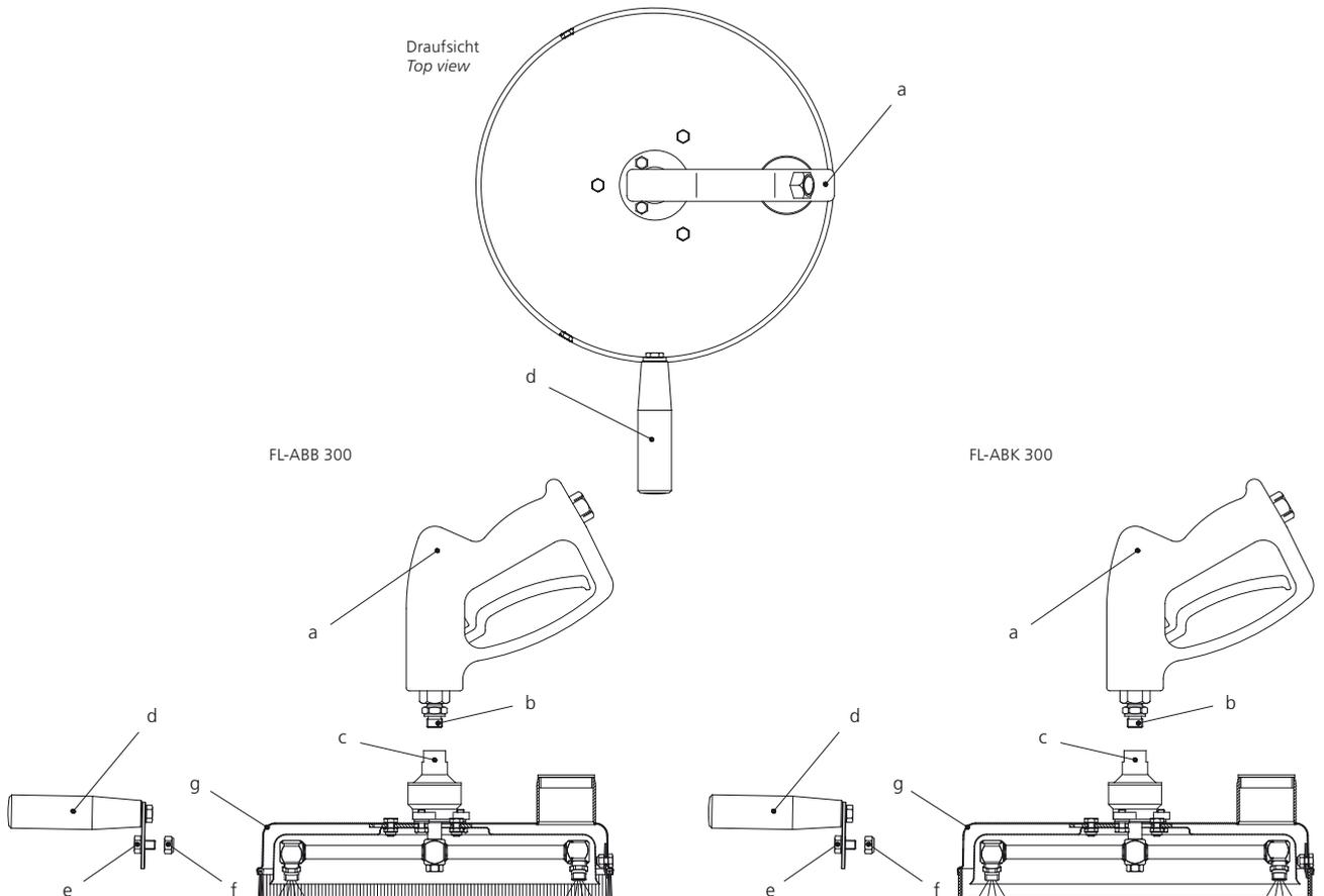
1. Die HD-Pistole (a) mittels der vormontierten Verschraubung (b) am Drehgelenk (c) anschliessen.
