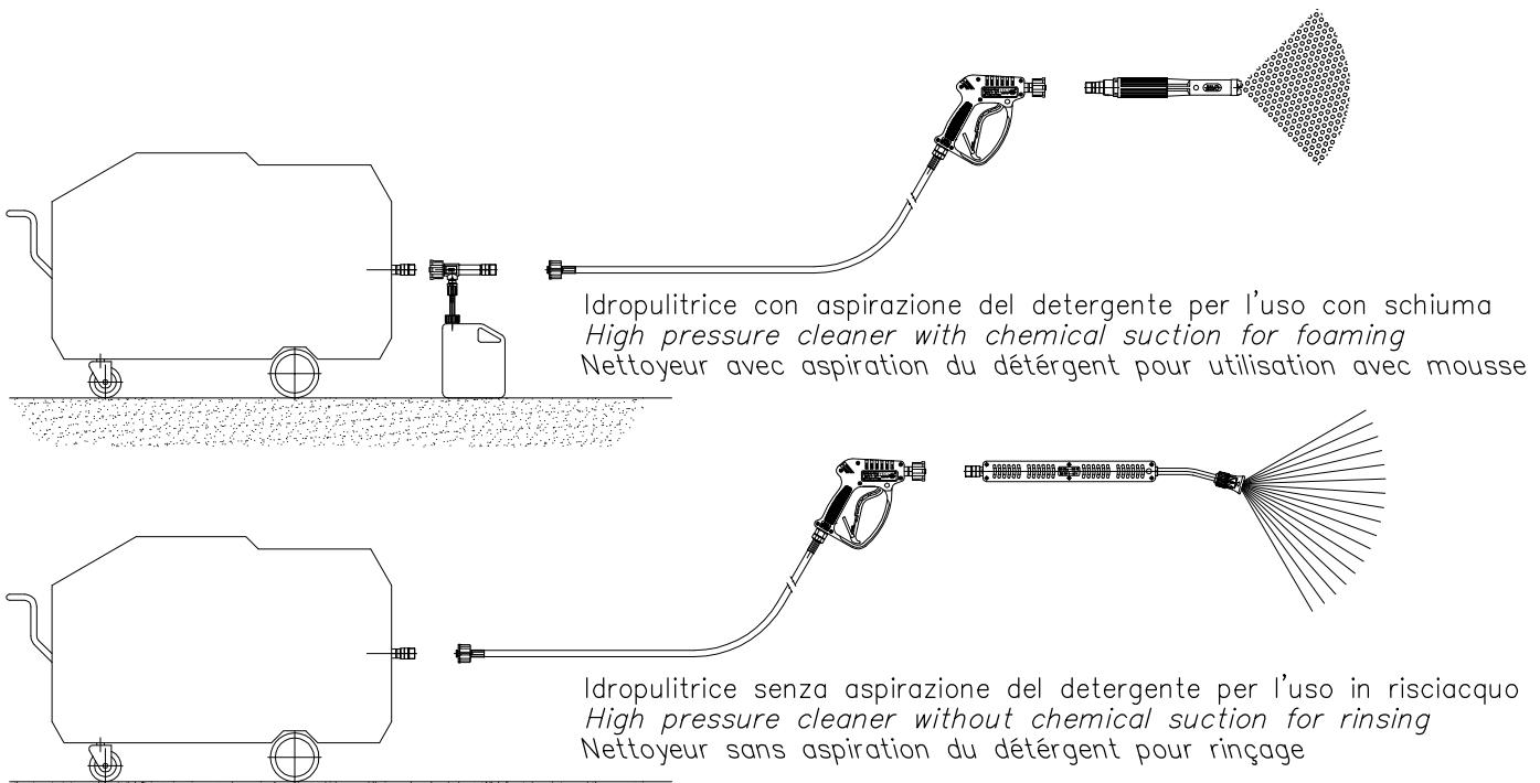
USO SU IMPIANTI FISSI DELLA LANCIA SCHIUMA LS12 CON ASPIRAZIONE ESTERNA + INIETTORE
